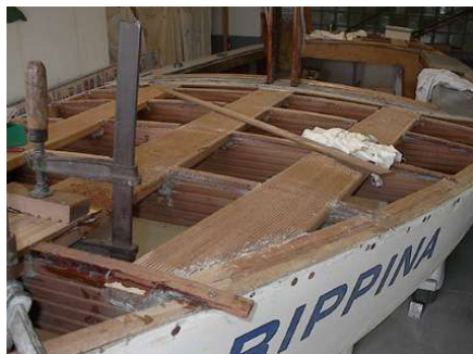
"Agrippina" ohne Deck, mit neuen Spanten, und viel Arbeit noch voraus
